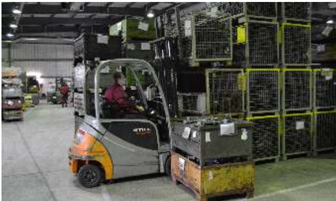
Einlagerung im Blocklager. Die Position wird mit Hilfe von Ortung und RFID erfasst.
